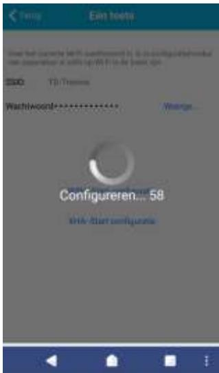
**Stap4:** Wacht 70 seconden, daarna kunt u op de betreffende camera klikken en het wachtwoord van de camera invoeren, dit is standaard "admin". Wanneer u dit heeft ingevoerd, klikt u op "opslaan" om de camera verbinding te laten maken met de Wifi.
