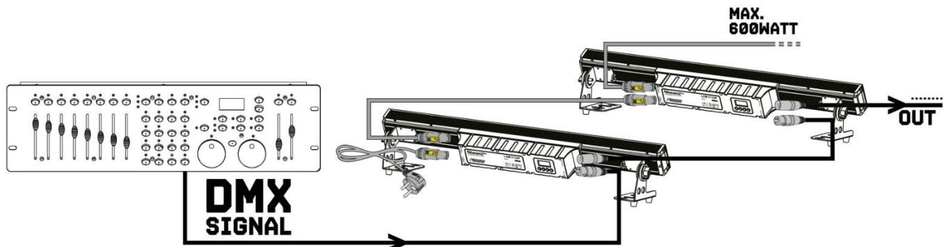
**ATENCIÓN!** En el último aparato, debe cerrar la línea DMX con una resistencia de terminación. Tome un conector XLR y suelde una resistencia de 120 Ohm entre la señal (-) y la señal (+) y conéctela a la salida DMX del último dispositivo en la línea.
