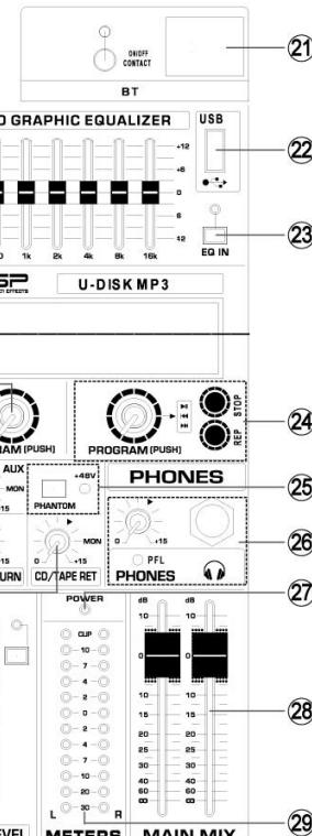
**NOTA:** El segmento "0" corresponde al nivel nominal de salida. El indicador de pico se ilumina en rojo cuando la salida alcanza el nivel de recorte.
