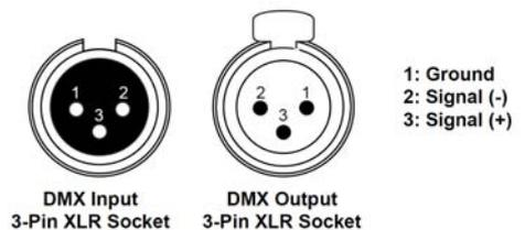
Attention : sur le dernier appareil, le cordon DMX doit être terminé par un bouchon. Soudez une résistance 120 ohms entre signal (-) et signal (+) sur une prise XLR 3 pôles et branchez-la à la sortie DMX du dernier appareil de la chaîne.
