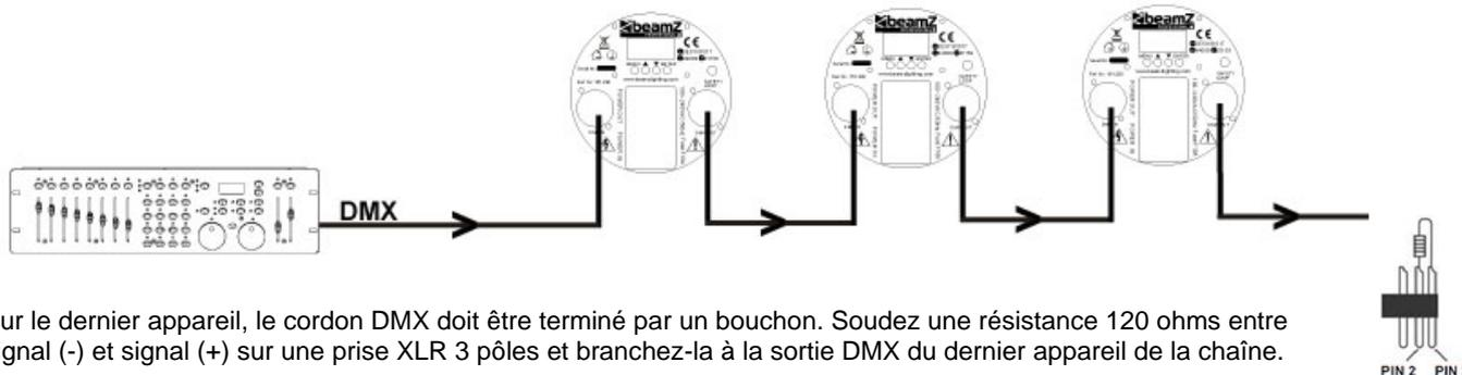
Sur le dernier appareil, le cordon DMX doit être terminé par un bouchon. Soudez une résistance 120 ohms entre signal (-) et signal (+) sur une prise XLR 3 pôles et branchez-la à la sortie DMX du dernier appareil de la chaîne.
