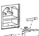
Krok 1: Otwórz śrubokrętem zasłonkę bezpiecznika na tylnym panelu.
