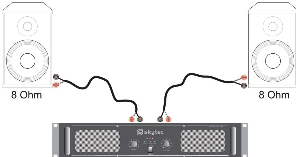
**Parallel aansluiting 4 Ohm / Connection in parallel 4Ω/ Connexion en parallèle 4Ω / Parallelanschluss 4Ω / Conexiones en paralelo 4Ω:**
